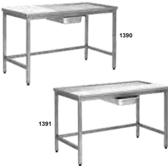
Plateau tôle **inox** brossé épaisseur **1,5** mm avec bords relevés **20** mm et évacuation sur **bac/tiroir** inox
